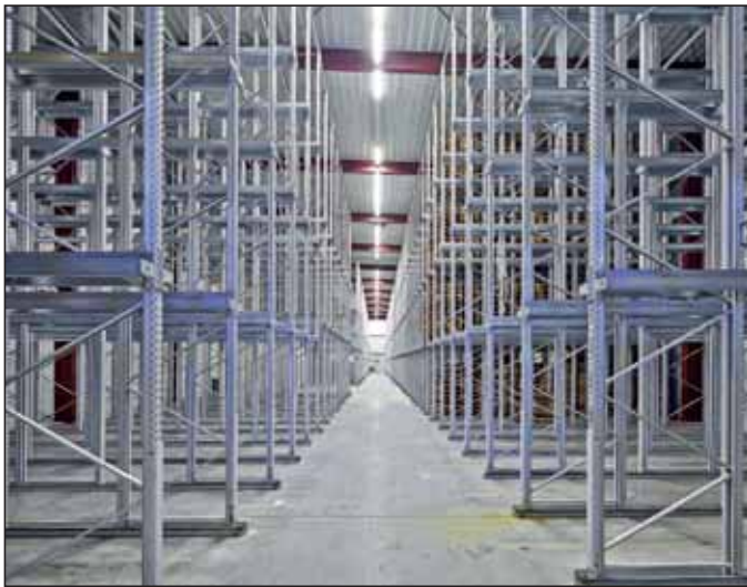
Innenansicht Kühlhalle mit Regalsystemen
